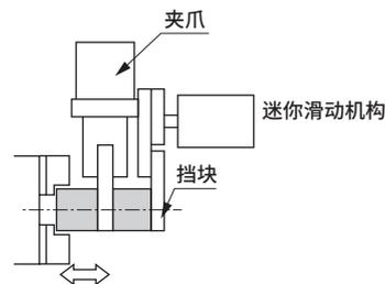
注) 由于工件在小爪上滑动，夹爪寿命可能会大幅降低。小爪的形状需要充分考虑。
